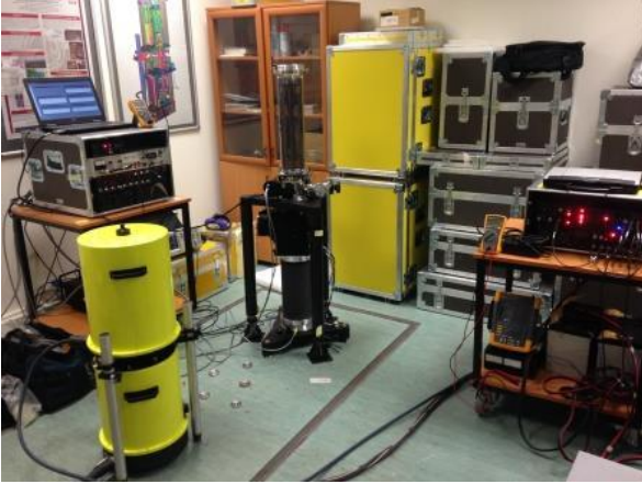
Şekil 7. FG-5X (#254) ve A-10 (#044) mutlak gravimetre karşılaştırması için laboratuvar çalışması.
