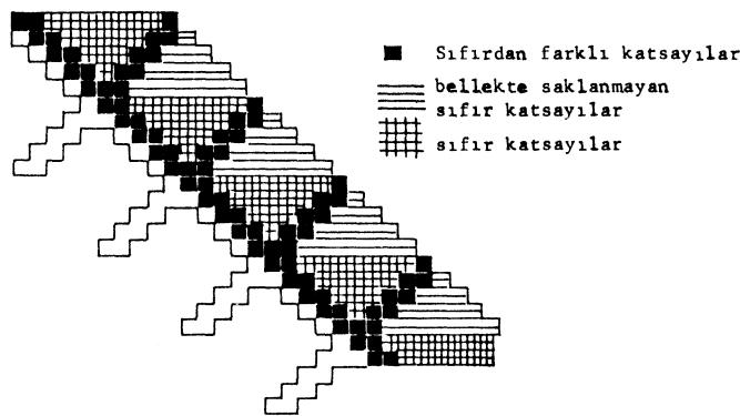
Şekil-8: Değişken bant matrisin lineer depolanması yönteminde
