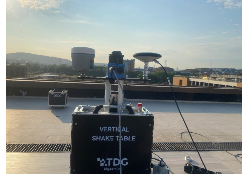
Şekil 2. Çalışmada kullanılan sarsma tablası ve GNSS antenleri.
