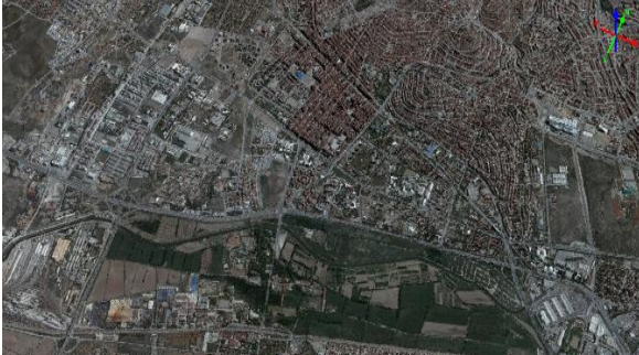
Şekil 6-a. Çankaya ilçesinin bir kısmının SYM üzerine ortofoto giydirilmiş görüntüsü.
