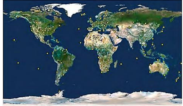
Şekil 3. Trimble ağına referans noktaları Alıcı sayısının kısıtlı olması servisin bir eksikliği olarak değerlendirilebilir.
