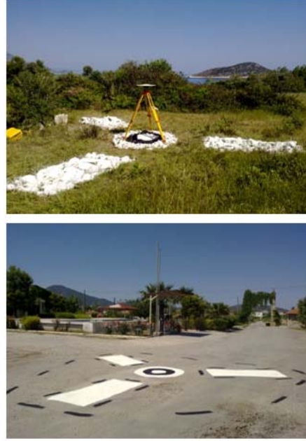
Şekil 2.3 Fotogrametrik nirengi noktası resimleri
